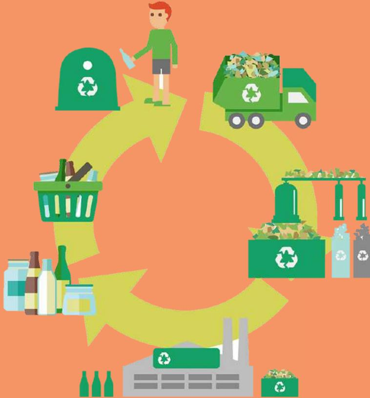
O vidro recebe uma lavagem (retirar sujidades) e em seguida passa por um processo de trituração. Os cacos são então aquecidos e fundidos a uma temperatura acima de 1300 °C. Após esse processo, garrafas, copos, etc., podem ser moldados e utilizados novamente.
